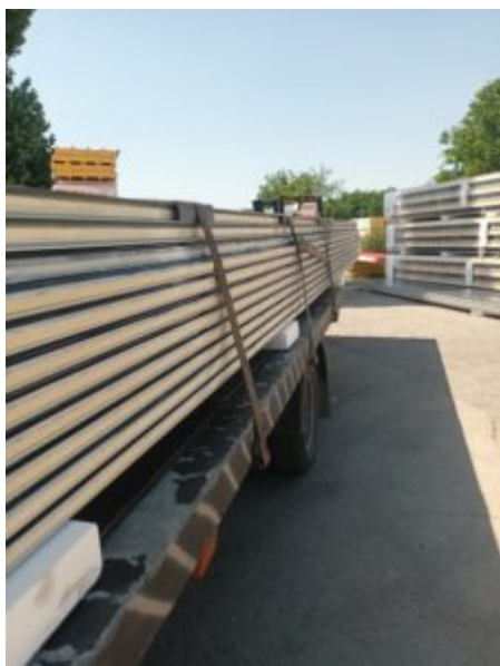
Prevoz PUR panelov
